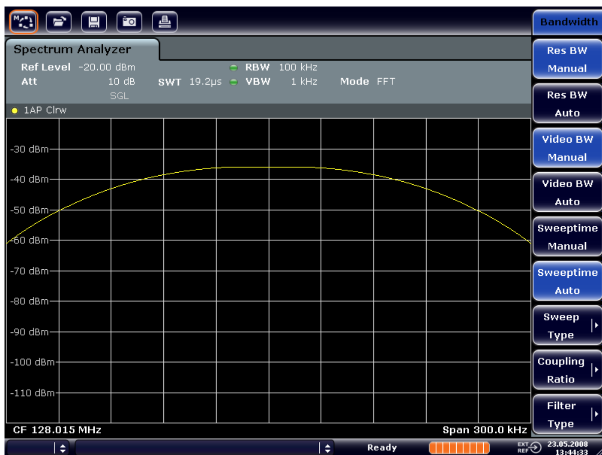
図 6-13: 同じレベルの 2 つの RF 正弦波信号を、信号の周波数間隔より広い分解能帯域幅で測定した結果
