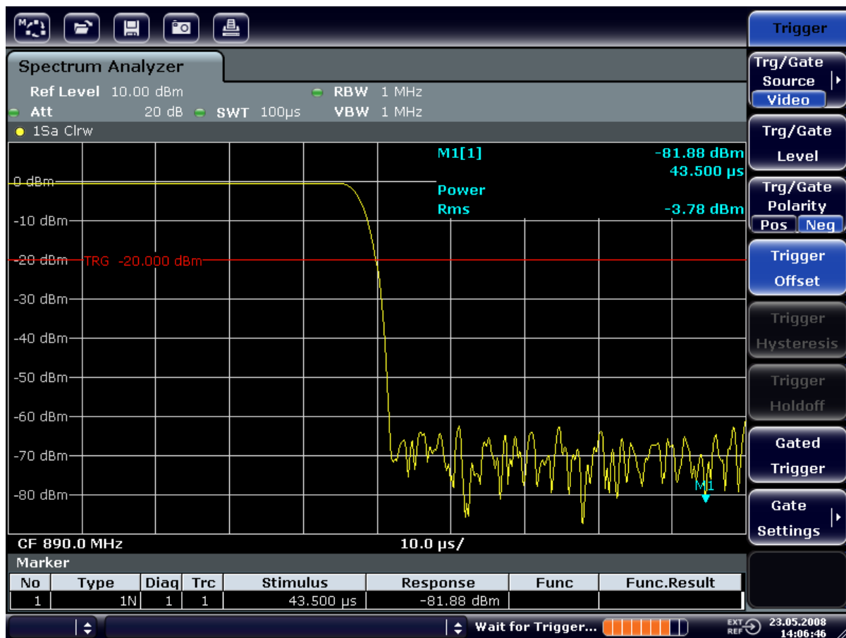
図 6-18: 時間分解能を上げて GSM バーストの立ち下がリエッジを表示
