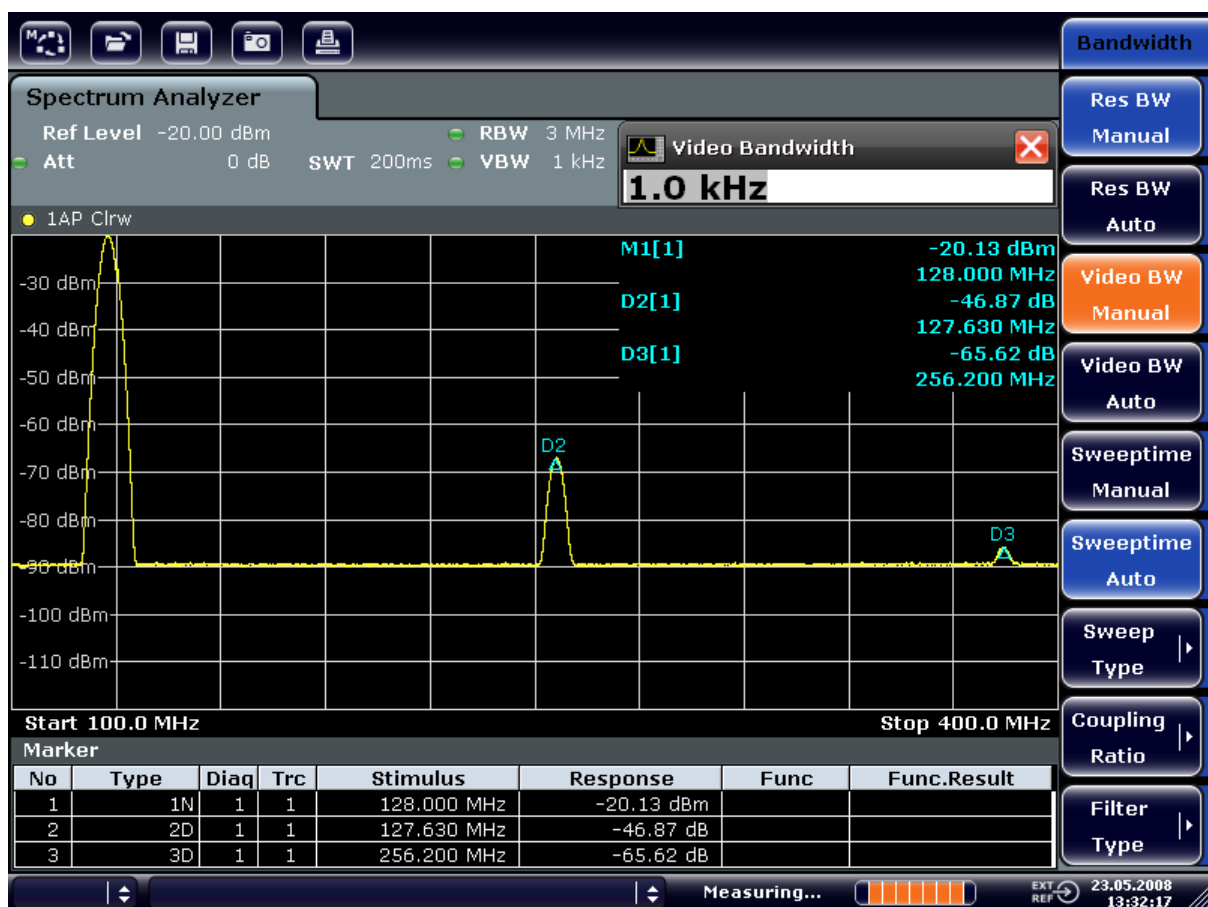
図 6-11: ビデオ帯域幅の縮小による高調波測定時の雑音を抑圧
